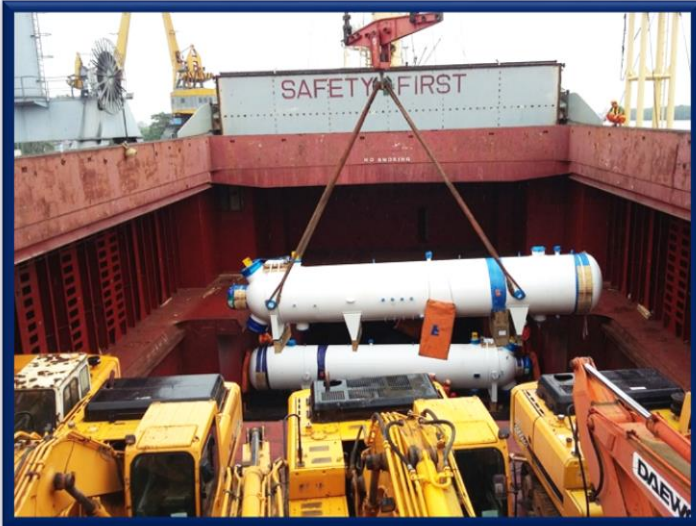
Vận chuyển và bàn giao 5 kiện Feed Heater Water tại dự án NM Nhiệt điện Mông Dương 1
